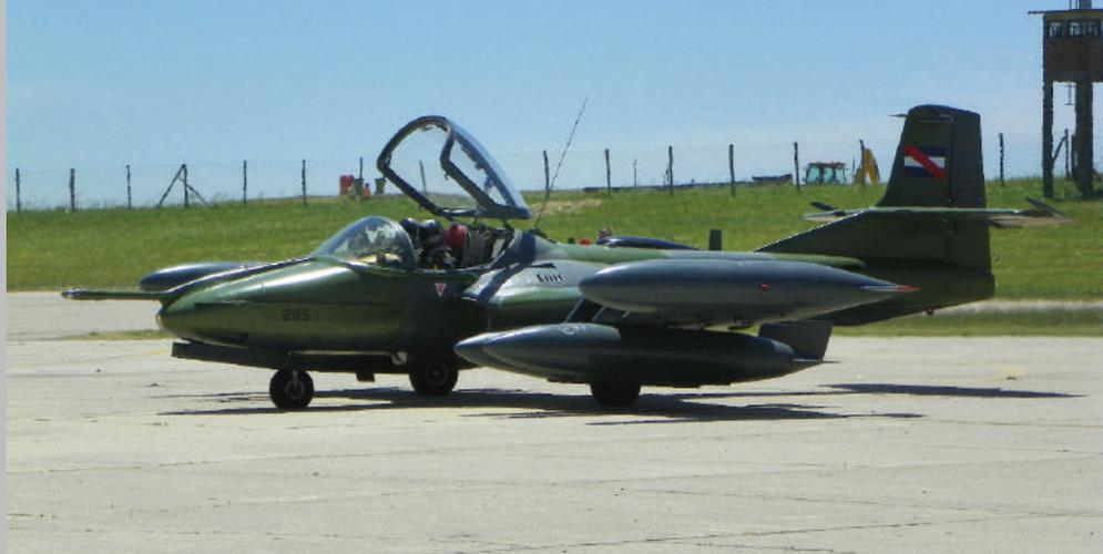
El Cessna A-37 "Dragonfly" es una aeronave biplaza subsónica de ataque ligero y propulsado por dos reactores J-85 General Electric, con amplia capacidad para portar armamento, con alas rectas y de origen norteamericano.
